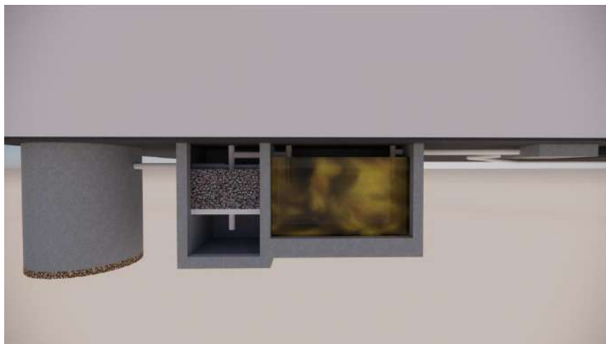
Figura 80: Esquema de utilização de soluções individuais de tratamento de esgotos sanitários (ilustração da vista inferior das estruturas)
