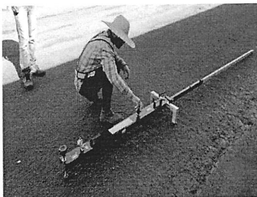
VIGA BENKELMAN EM OPERAÇÃO.
