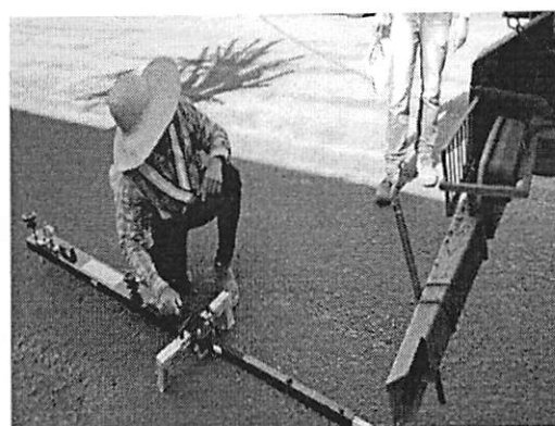
VIGA BENKELMAN EM OPERAÇÃO.
